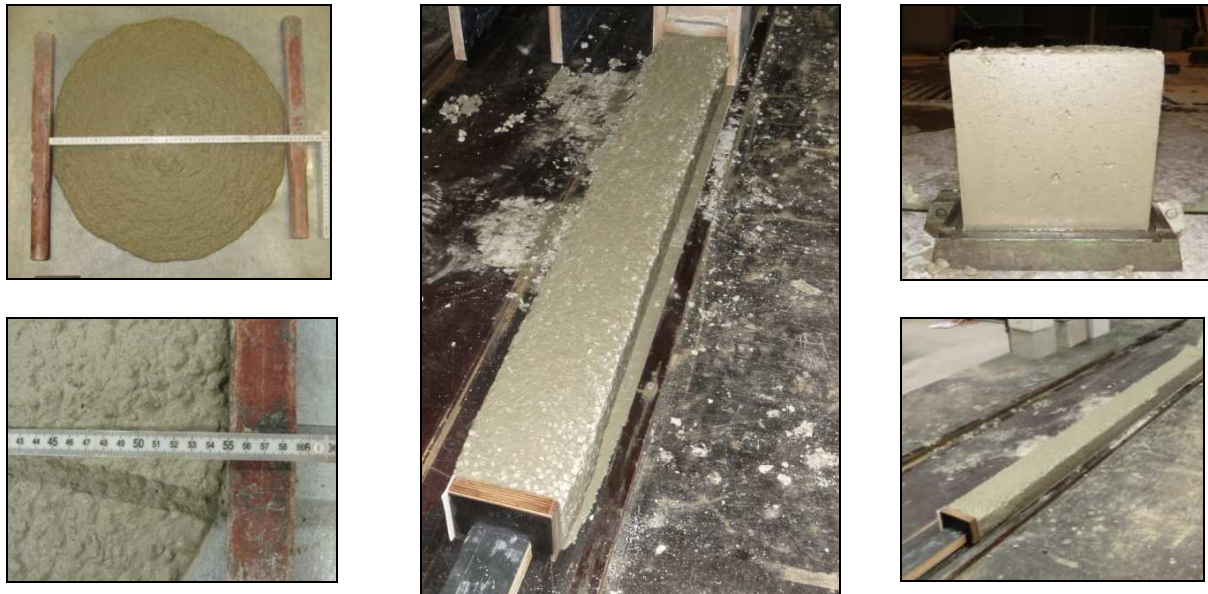
Abbildung 113: Setzfließmaß (530 mm) und Formstabilitätskoeffizient ( K_{MP3} = 0,87 ) der Mischung M-17
