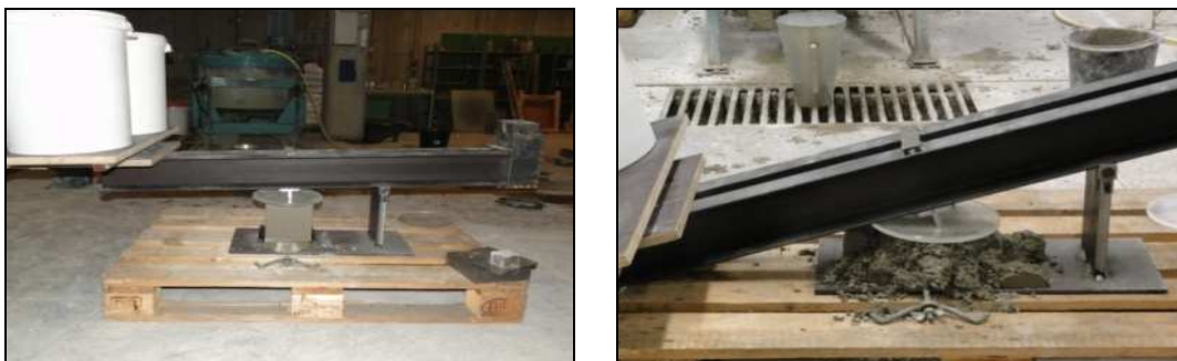
Abbildung 83: Bestimmung der Grünstandfestigkeit
