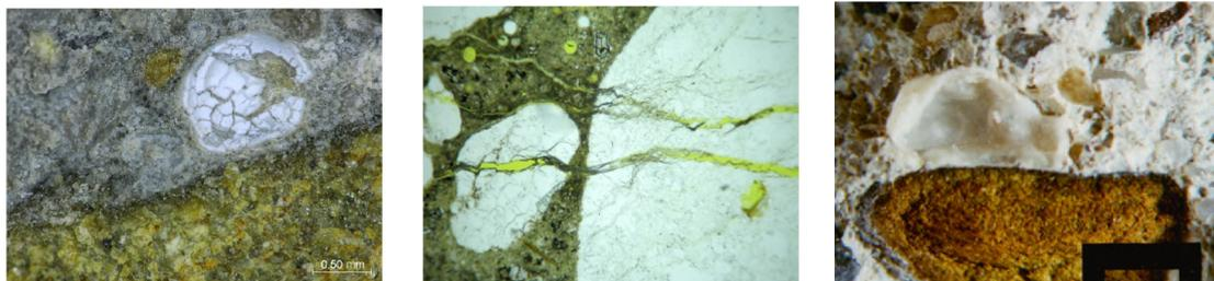
(a) Getrocknetes, schollenartig gerissenes AKR-Gel in der Pore eines geschädigten Betons [3]
