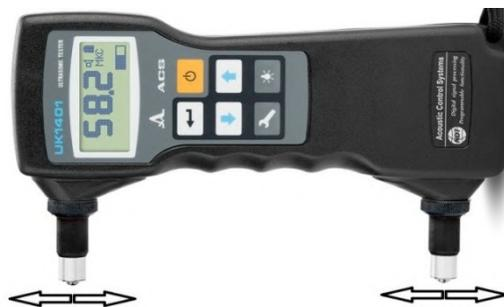
Abbildung 3.8: Ultraschallhandgerät UK 1401, Schwingungsrichtung der Prüfköpfe
