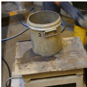
(a) Rütteltisch mit Behälter zur Bestimmung der Frischbetonrohichte
