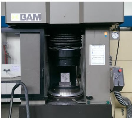
(a) Prüfmaschine zur Bestimmung der Druckfestigkeit
