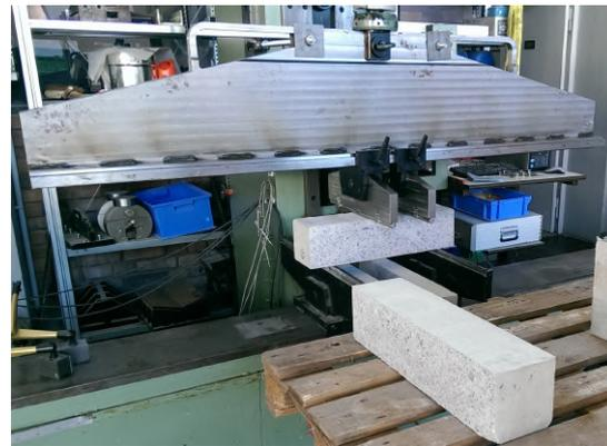
(b) Prüfmaschine zur Bestimmung der Biegezugfestigkeit
