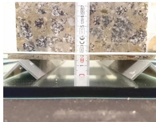
Abbildung 4.17: Beispielhafte Darstellung des Eintauchens der Prüfkörper während der kapillaren Saugversuche
