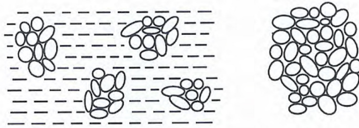
Abbildung 3-4: Zementleimmodell nach Powers: Agglomeration von Partikeln in einer verdünnten (links) und einer konzentrierten Suspension (rechts) [Pow68]
