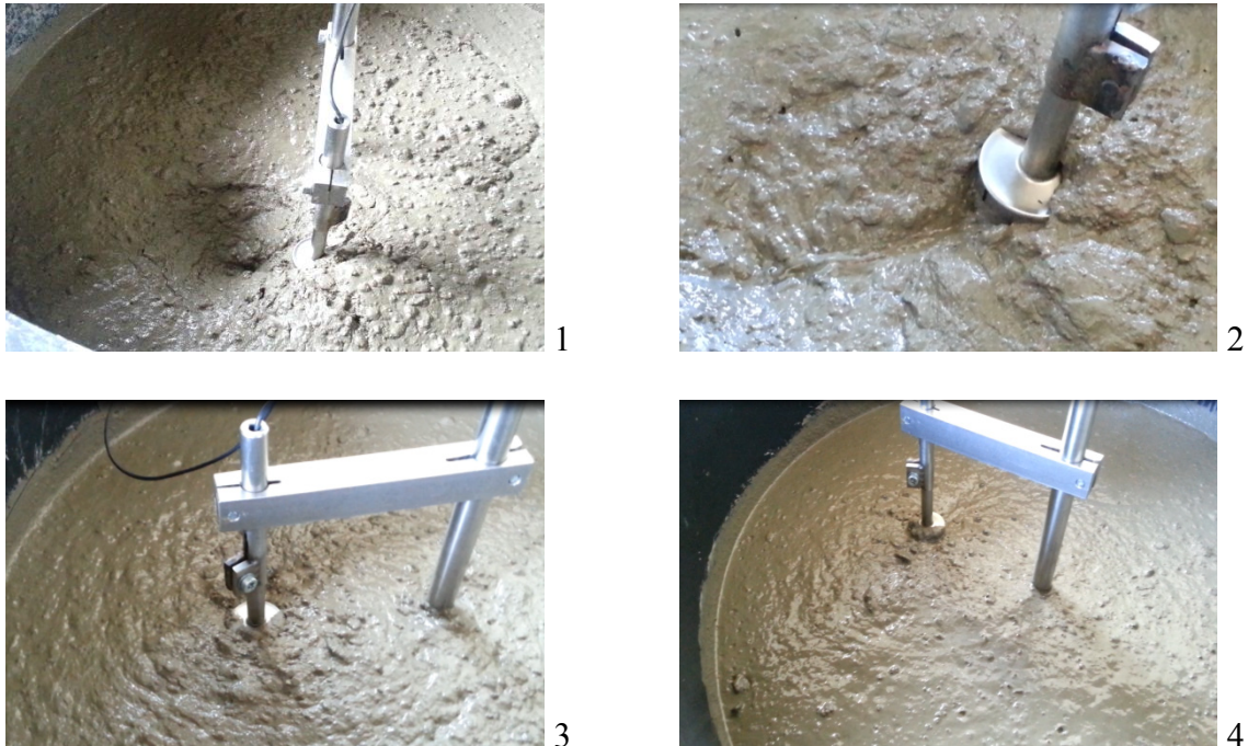
Abbildung 5-29: Umströmung der Kugel bei unterschiedlicher Viskosität und Geschwindigkeit: 1 hohe Viskosität ( \sim 450 Pas), langsam ( \dot{\gamma} = 0,006 1/s); 2 mittlere Viskosität ( \sim 220 Pas), langsam ( \dot{\gamma} = 0,006 1/s); 3 niedrige Viskosität ( \sim 90 Pas), schnell ( \dot{\gamma} = 0,123 1/s); 4 niedrige Viskosität ( \sim 90 Pas), langsam ( \dot{\gamma} = 0,006 1/s)
