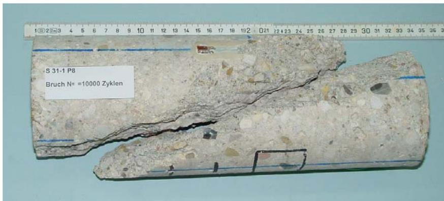
Bild 2.13: Ermüdungsbruchfigur eines Betonprobekörpers
