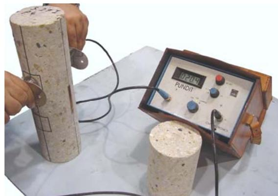
Bild 3.4: Achsen für die Ultraschalllaufzeit-Messung (links) und Durchführung (rechts)
