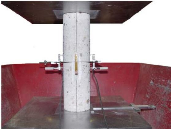
Bild 3.6: Ermittlung der Spannungs-Dehnungslinie mit DD1-Aufnehmern
