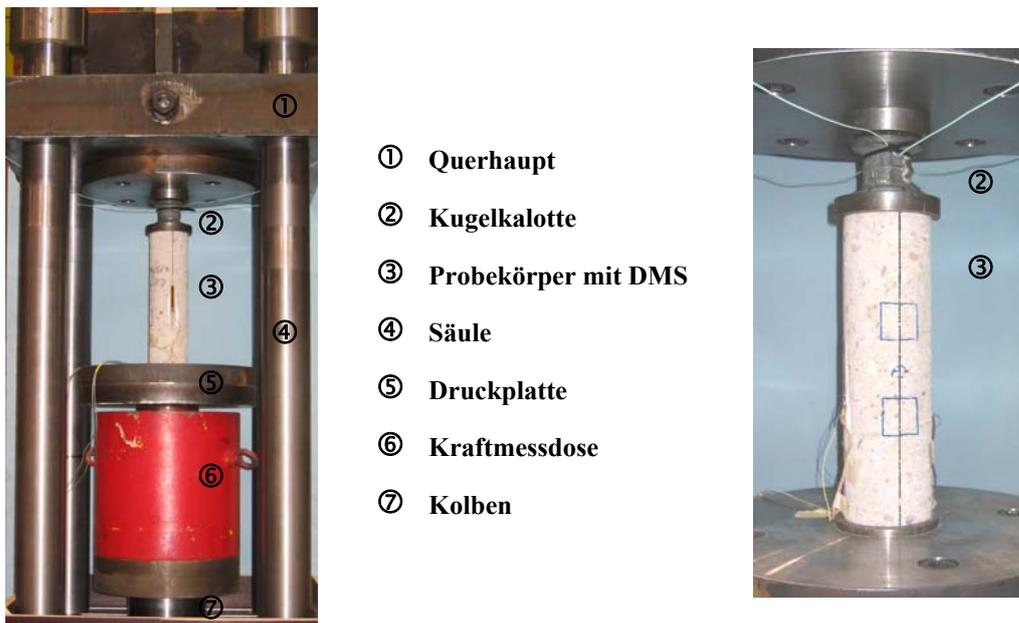
Bild 3.3: Hydropulsanlage (links) und Probekörper mit Lasteinleitung über Kugelkalotte (rechts)
