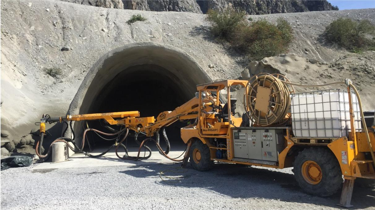
*Abbildung 41: Mobile Spritzbetonmaschine vor Versuchsstollen*
