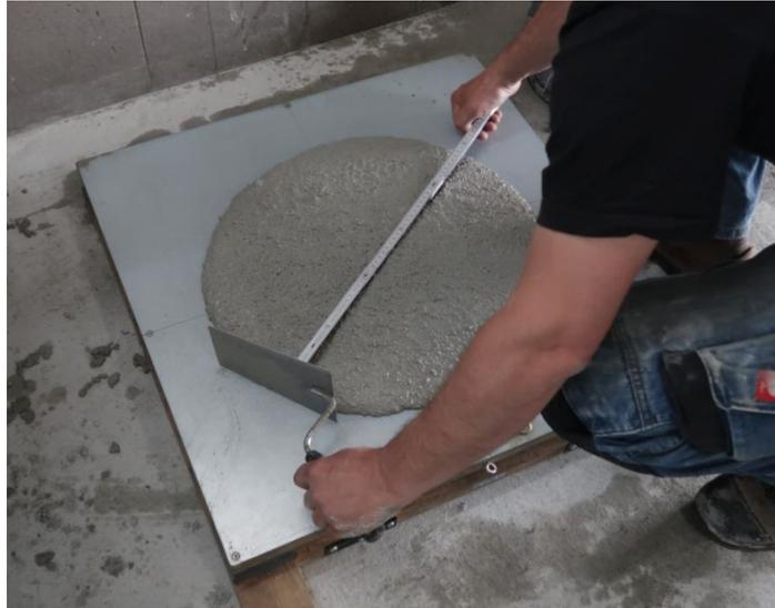
Abbildung 83: Optisch keine Entmischung anhand des Ausbreitmaßes bei Mischung B5 erkennbar (Prüfzeitpunkt ca. 25 min nach Wasserzugabe im Mischer)
