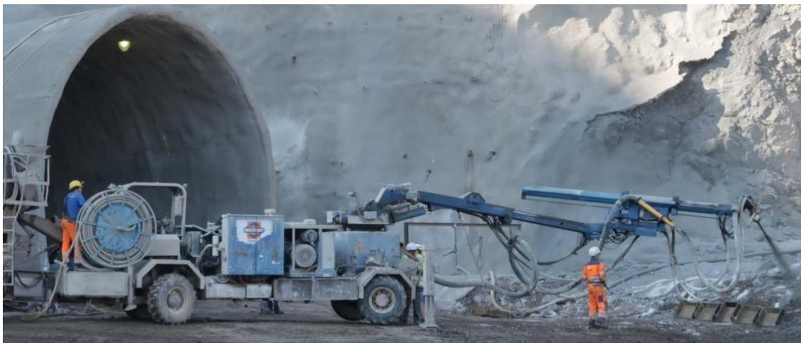
*Abbildung 2: Beispiel einer mobilen Spritzbetonmaschine für Nassspritzverfahren mit Dichtstromförderung [Florian Steindl, TU Graz]*
