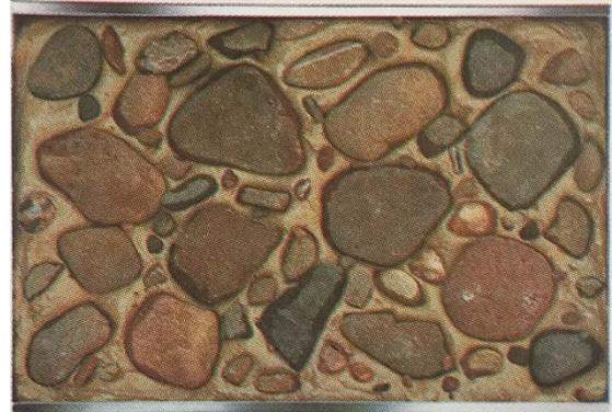
Abbildung 37: *Querschnitt durch einen Förderschlauch a) eines schlecht pumpbaren Betons und b) eines gut pumpbaren Betons beurteilt nach dem Leimvolumen [15]*
