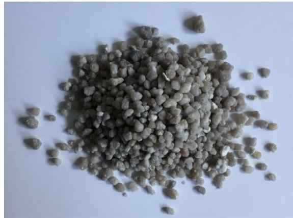
Abbildung 42: Quarzitischer Sand a) Kornfraktion 0,1-0,5 mm b) Kornfraktion 3-5 mm
