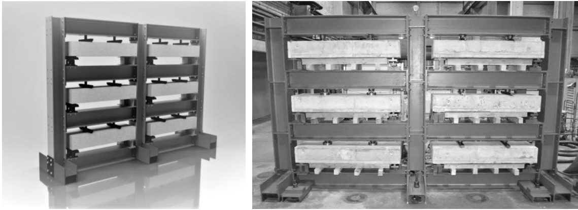
Abbildung 48: Visualisiertes Konzept des Mehrfachprüfstandes [203](links) und ausgeführter Mehrfachprüfstand [203, 204, 206] (rechts)
