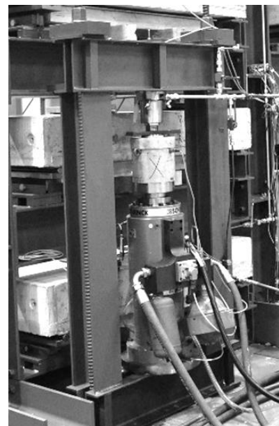
Abbildung 49: Konzept des Hydrauliksystems (links) und servo-hydraulischer Zylinder an der Rückseite des Mehrfachprüfstandes [203](rechts)
