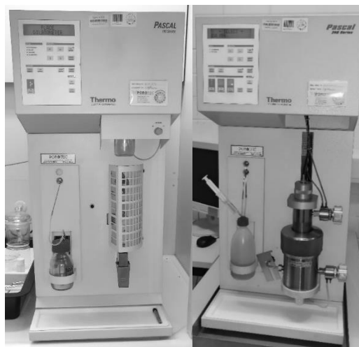
Abbildung 45: Hg-Porosimeter vom Typ Pascal 140 für den Niederdruckbereich (links) und vom Typ Pascal 240 für den Hochdruckbereich (rechts)
