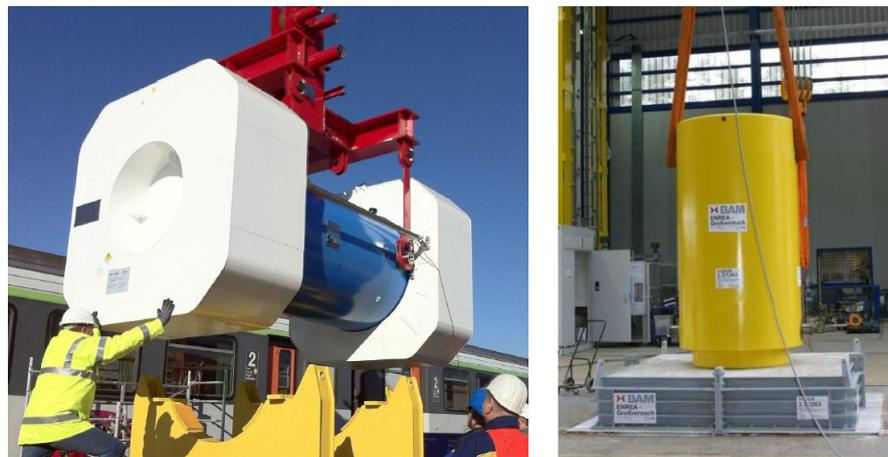
Abbildung 49: Gefahrstoffbehälter mit Stoßdämpferelementen [91] (links) und Stoßdämpferfundament [72] (rechts).
