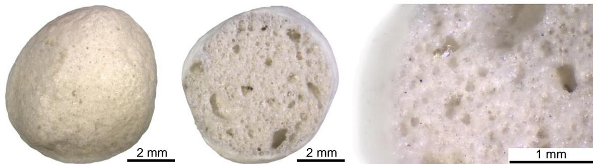
Abbildung 58: Charakteristische Kornstruktur von Blähglas: Mikroskopische Aufnahmen eines Blähglaskorns von außen (links) und im Querschnitt (Mitte und rechts).
