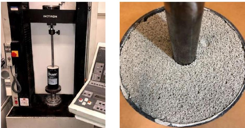
Abbildung 28: Versuchsaufbau für teilflächige Stauchversuche mit Querdehnungsbehinderung aus [62].
