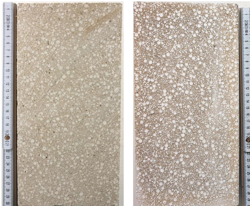
Abbildung 98: Schnittbilder von Zylinderproben ( h_0/D = 300 \text{ mm}/150 \text{ mm} ) des Betons mit Blähglas 0,5/8 mm (links) bzw. EPS-Perlen 0,5/5 mm (rechts).
