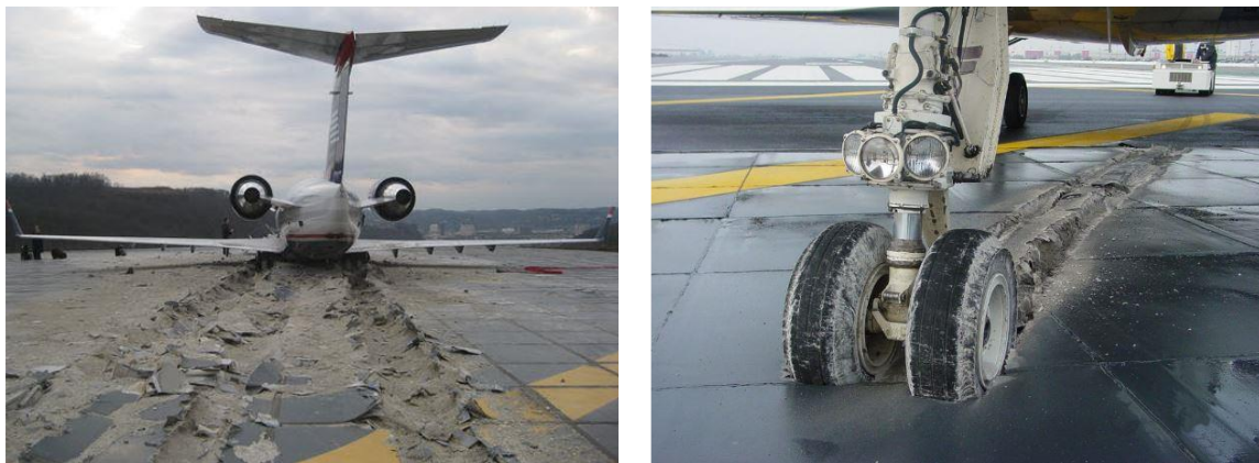
Abbildung 50: Fotos eines Notfall-Stoppsystems (Engineered Material Arresting System) für Flugzeuge auf Start- und Landebahnen aus zementgebundenen Materialien mit hohem plastischen Stauchvermögen (links: [96], rechts: [97]).
