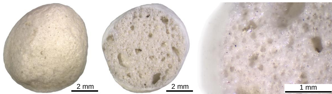
Abbildung 58: Charakteristische Kornstruktur von Blähglas: Mikroskopische Aufnahmen eines Blähglaskorns von außen (links) und im Querschnitt (Mitte und rechts).
