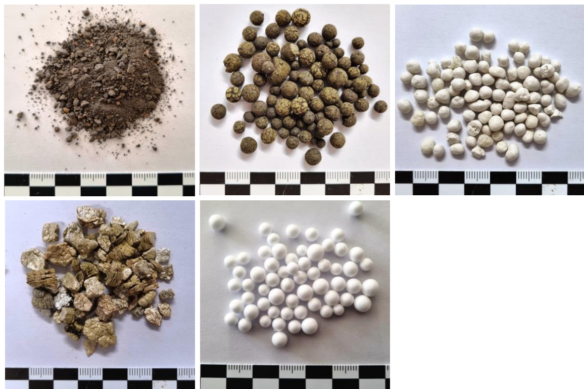
Abbildung 52: Poröse Zuschlagstoffe (v.o.l.n.u.r.): Blähton-Leichtsand 0/2 mm, Blähton 2/8 mm, Blähglas 2/4 mm, Vermiculite 2/8 mm, EPS-Perlen 2/5 mm.
