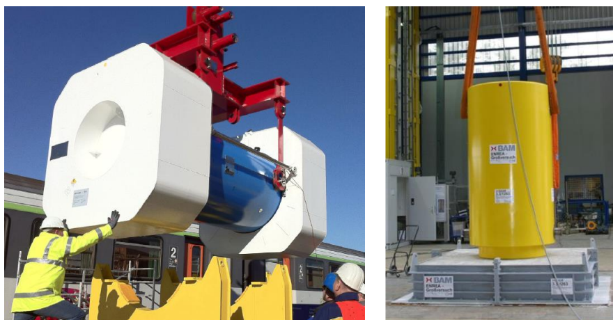
Abbildung 49: Gefahrstoffbehälter mit Stoßdämpferelementen [91] (links) und Stoßdämpferfundament [72] (rechts).
