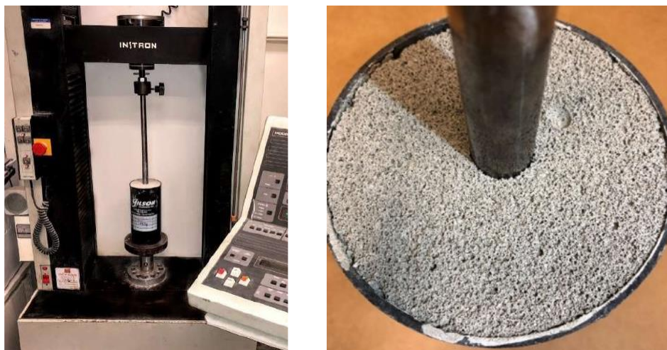
Abbildung 28: Versuchsaufbau für teilflächige Stauchversuche mit Querdehnungsbehinderung aus [62].
